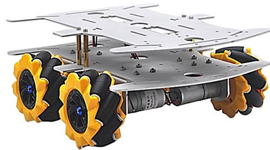
Abb. 2: Bewegliche Plattform mit Mecanum Rädern
