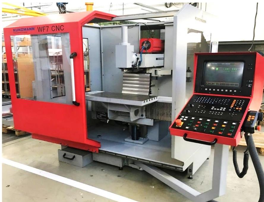
**CNC-Fräsmaschine mit Bedienpult** <sup>10</sup>
