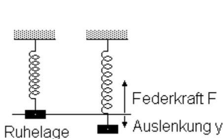
Abb. 1: Auslenkung beim Federpendel<sup>1</sup>
