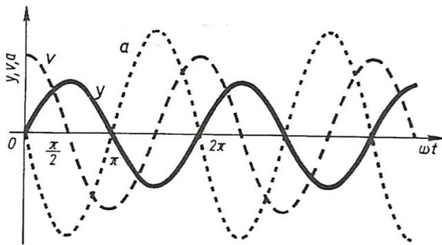
Abb. 5: Auslenkung  $y$ , Geschwindigkeit  $v$  und Beschleunigung  $a$  einer harmonischen Schwingung<sup>5</sup>
