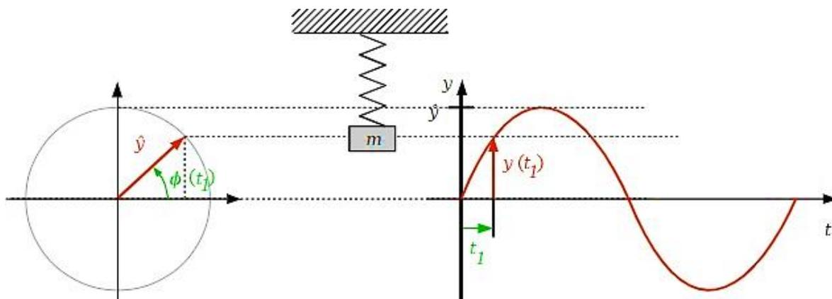
Abb. 6: Zeiger- und Liniendiagramm am Beispiel eines Federpendels<sup>6</sup>
