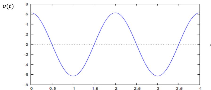
Abb. 9: Geschwindigkeitsfunktion (Kosinus) einer harmonischen Schwingung
