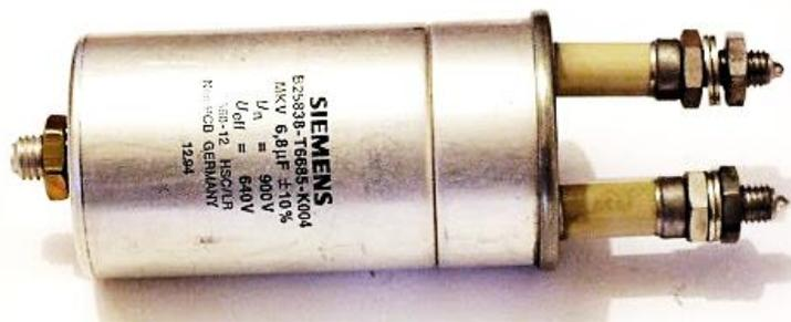
Abb. 5-2: Becherkondensator<sup>15</sup>
