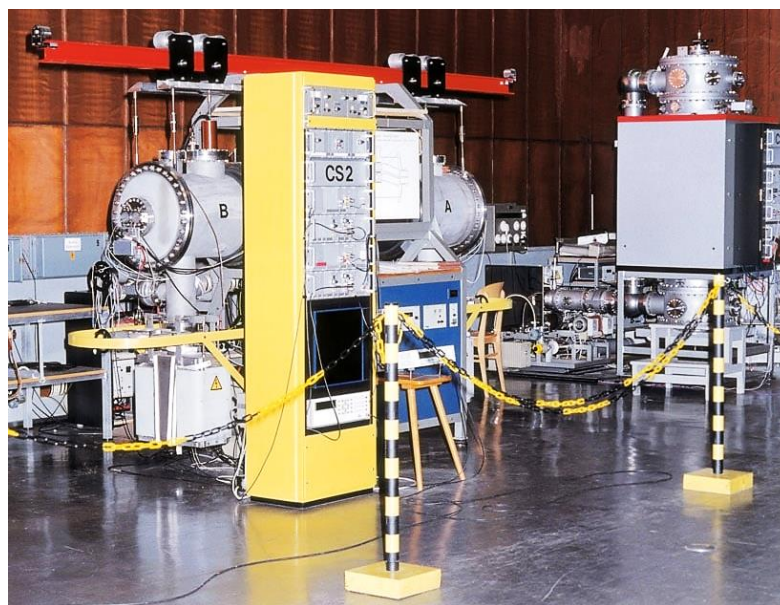
Abb. 4-1: Atomuhr CS 2 (Physikalisch-Technische Bundesanstalt, Braunschweig)
