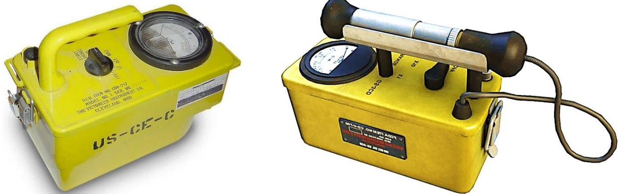
**Abb. 7: Ältere Geiger-Müller-Counter mit analoger Anzeige**
