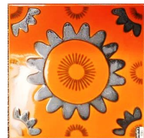
d) Decor-Fliese mit radioaktiver Glasur
