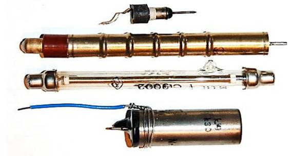
Abb. 5: Verschiedene Zählrohre<sup>20</sup>
