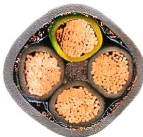
b) Energiekabel mit fehlendem Füllstoff; die Schwadensicherheit wird nicht erfüllt.
