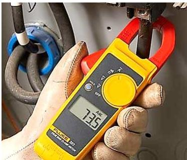
Abb. 25: Strommessung mit einem Clammeter
