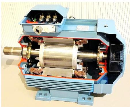
Abb. 12: Kurzschlussläufer<sup>7</sup>
