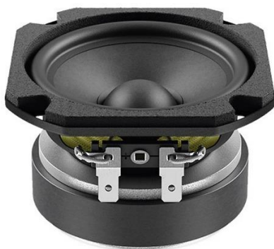
Abb. 9: Breitbandlautsprecher (120 Hz - 21 kHz)
