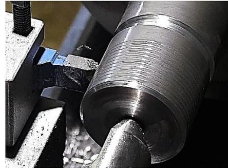
Beispiele für korrektes Einspannen des Drehstahls
