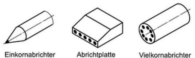
Abb. 11: Abrichtwerkzeuge<sup>12</sup>
