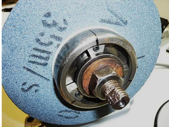
Abb. 13: Auswuchten mittels verschiebbarer Ausgleichsgewichte am Scheibenflansch
