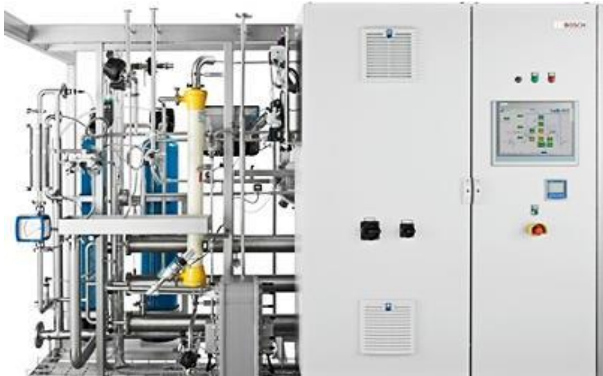
Abb. 2: Anlage zur Erzeugung von Highly Purified Water (HPW)
