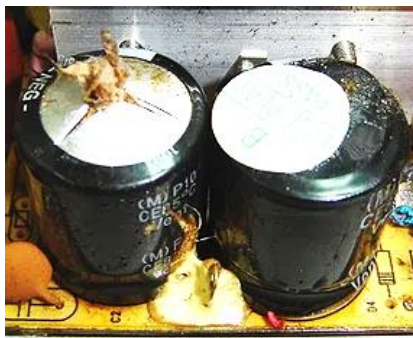
a) Beschädigte ELKOs mit Sollbruchstelle 28
