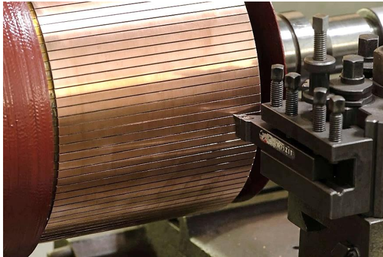
Abb. 60: Anker mit Kommutator zur Revision auf der Drehmaschine 43
