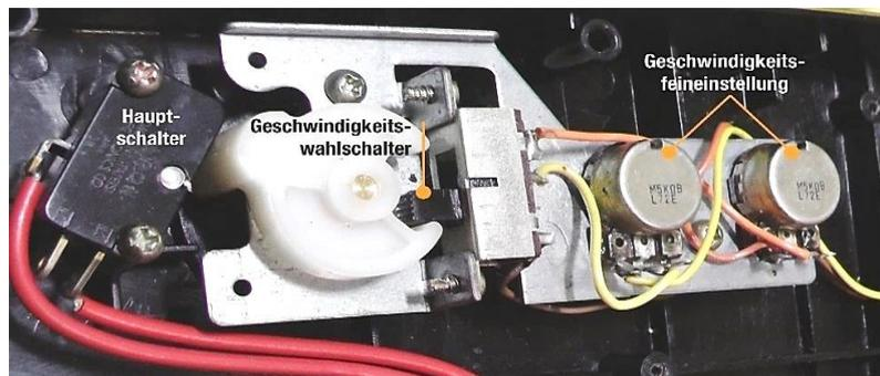
Abb. 2-10: Drehzahlkorrektur mit Pitch-Potentiometer<sup>26</sup>
