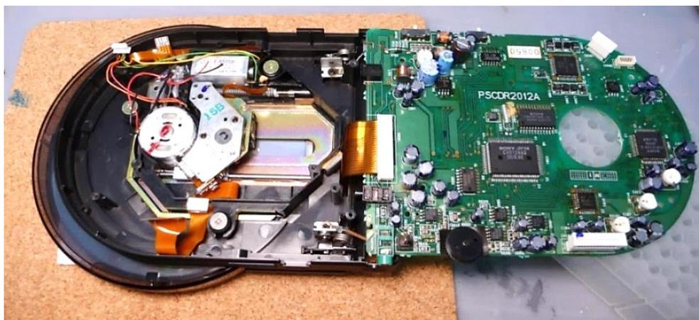
Abb. 4-3: Aufgeklappter CD-Player mit SMD-Bauteilen<sup>47</sup>
