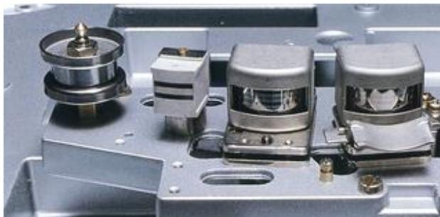
Abb. 3-13: Lösch-, Sprech- und Hörkopf<sup>37</sup>
