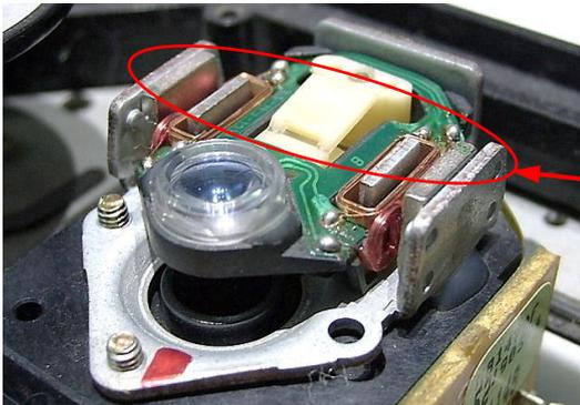
Abb. 4-7a: Objektiv mit Tracking- und Fokusserspulen<sup>52</sup>
