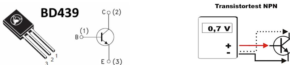
Abb. 1-19: Transistorprüfung am Beispiel eines NPN-Transistor
