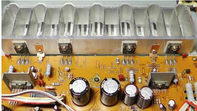
Abb. 1-12: Leistungstransistoren auf einem Aluminium-Kühlkörper<sup>12</sup>
