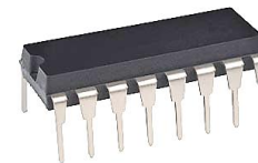
Abb. 25: Optokoppler als galvanische Trennstelle zwischen Steuer- und Lastteil 47
