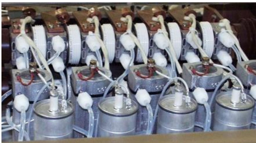
Abb. 19: Wassergekühlte Scheibenthristoren (2 kA, 10 kV) 39
